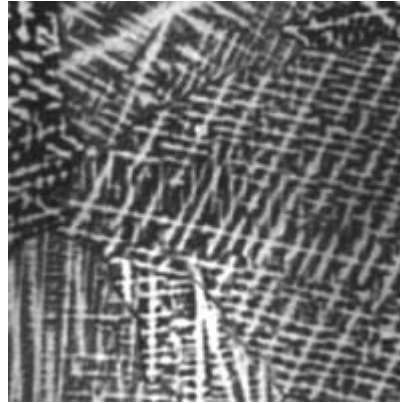
70/30 Laiton, coulé en sable, solution alcoolique de chlorure ferrique, x100
