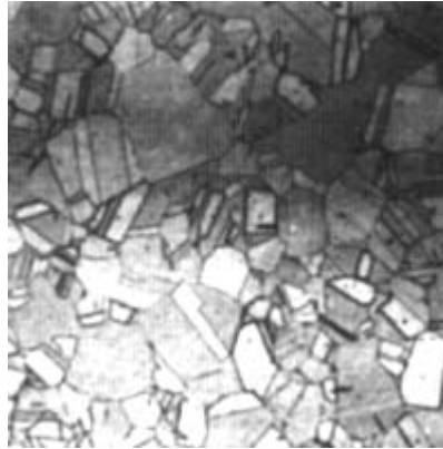
70/30 laiton, déformé à froid et recuit, solution alcoolique de chlorure ferrique, x200
