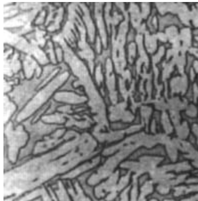
60/40 laiton, coulé en sable, Persulfate d'ammonium en milieu ammoniacal, x100
